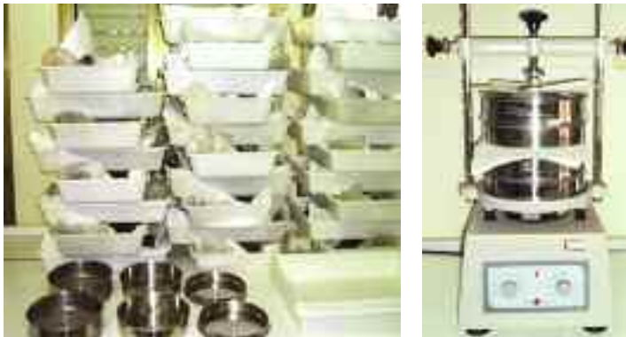
Figuras 9 y 10. Bandejas de plástico cubiertas con papel de filtro donde se dejaban a secar las muestras de suelo para proceder posteriormente al tamizado (izquierda). Tamizado con ayuda de un vibrotamizador (derecha).
