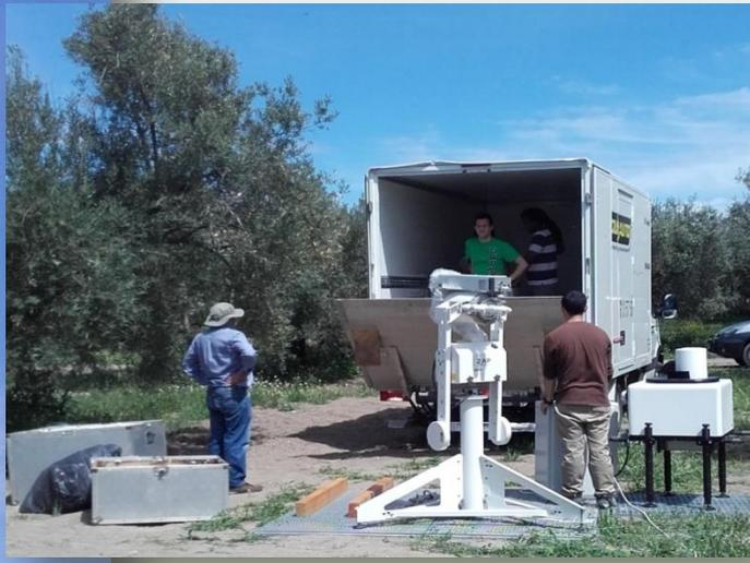
Medidor de partículas inferior a 800 nanómetros.
