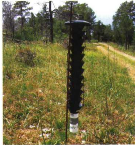
Figura 5. Trampa "Lindgren" modificada
