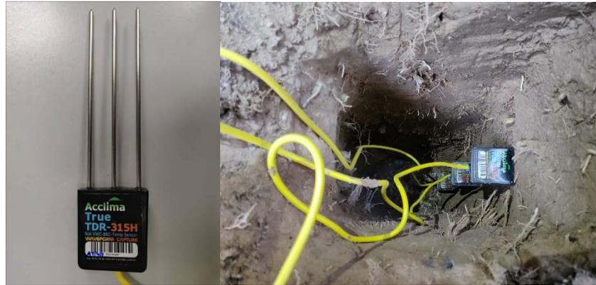
**Figura 5.** Acclima TDR-315H. Sonda e instalación. Fuente: Grau (2018).
