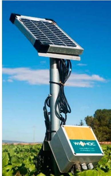
**Figura 23.** Datalogger S-WIDE. Fuente: [www.iagua.es](http://www.iagua.es).
