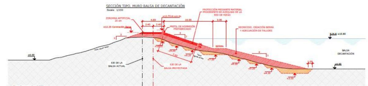
Figura 7. Sección tipo. Dique recreido de la balsa de decantación
