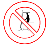
PROHIBIDO A LOS VEHICULOS DE MANUTENCION
