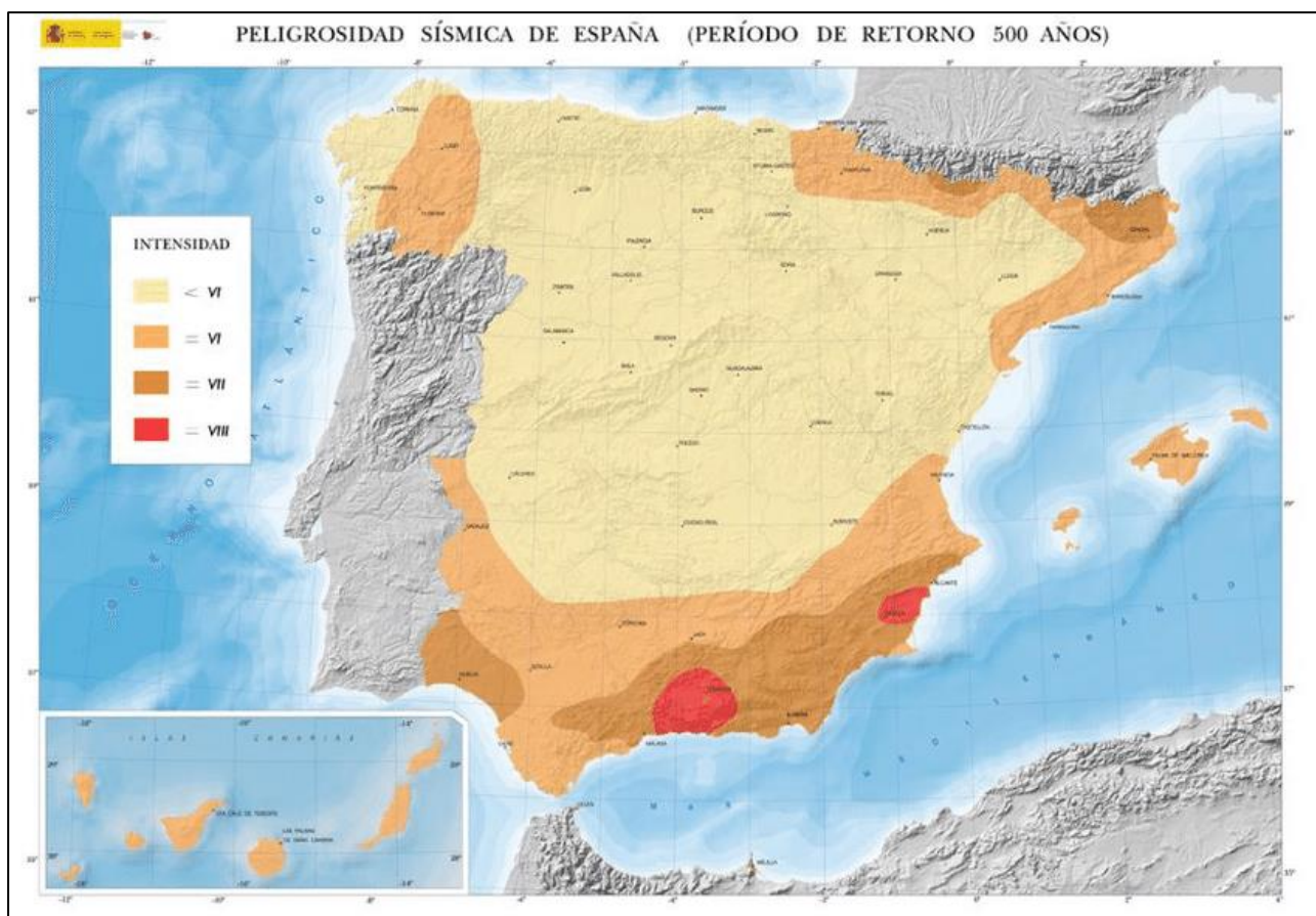
Figura 10. Mapa de peligrosidad sísmica según criterios de intensidad. Periodo de retorno 500 años. Fuente: IGN
