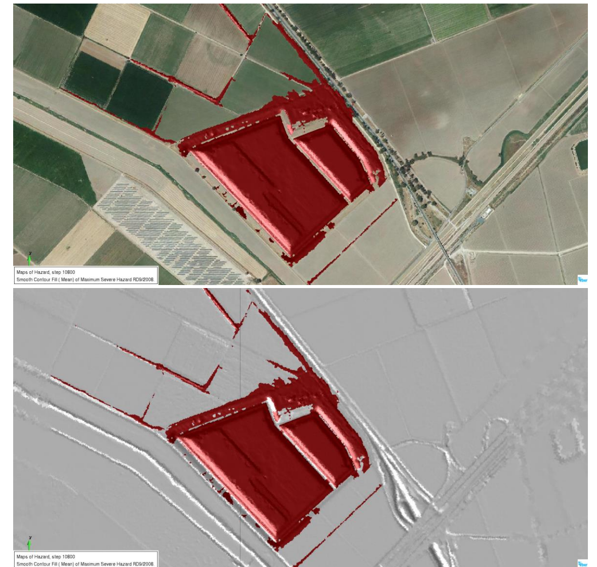
Figura 62. Zonas de graves daños según criterio de RD9/2008 en estado actual
