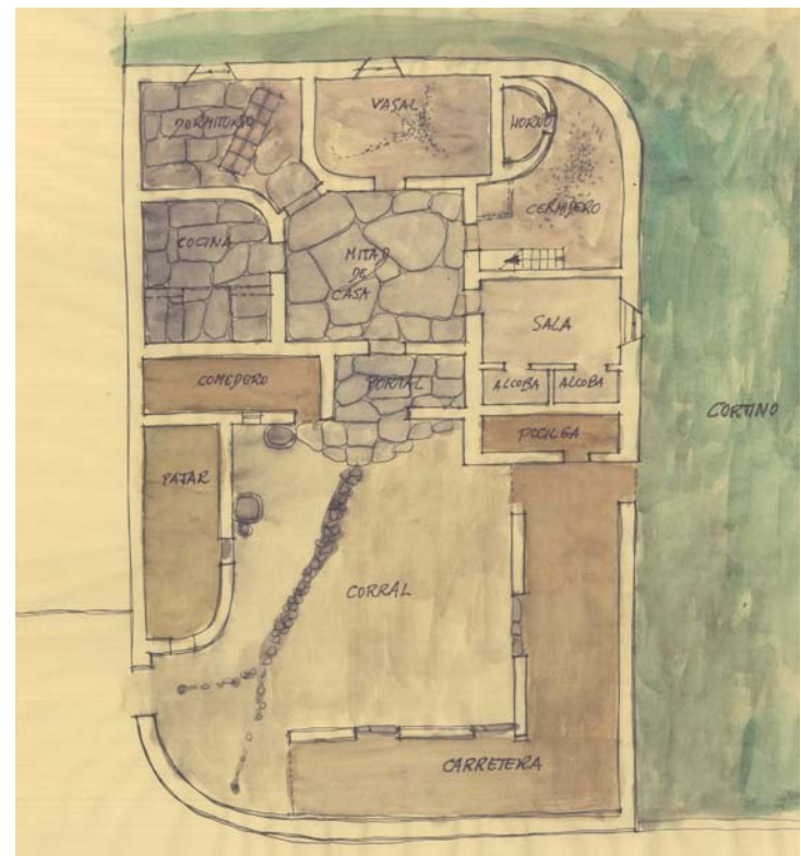
Figura 4. Organización espacial de casa de labranza en Sayago. Corral, "carretera", comedero, pajar y cernidero. Vivienda: portal, mitad de casa, sala con alcobas, vasal y cocina. Dibujo a tinta y acuarela.
