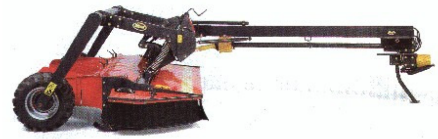
Segadora de discos arrastrada con suspensión de los dispositivos de siega y acondicionado
