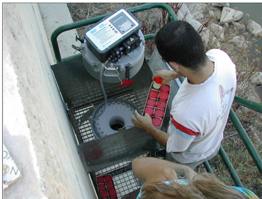
Figura 15. Toma muestras automático con programador. Las muestras hay que recogerlas de forma manual y enviarlas al laboratorio.
