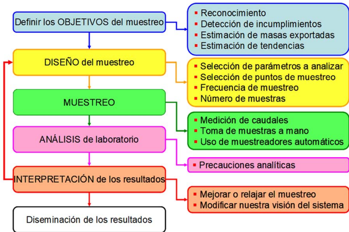
Figura 1. Pasos a seguir en la definición y ejecución de un plan de muestreo de las aguas de retorno de riego.
