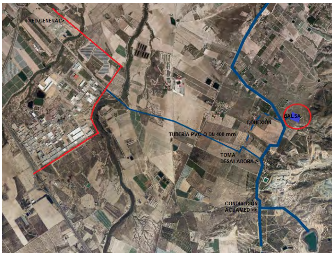
Fig. nº 17. Tubería de Acuamed y de servicio de la C.R.
