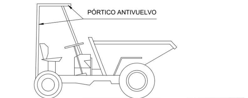
LOS VEHÍCULOS QUE NO TENGAN CABINA CUBIERTA PARA EL CONDUCTOR, DEBERÁN SER PROVISTOS DE PÓRTICO DE SEGURIDAD PARA EL CASO DE VUELCO. (ART. 124 O.G.S.M.)
