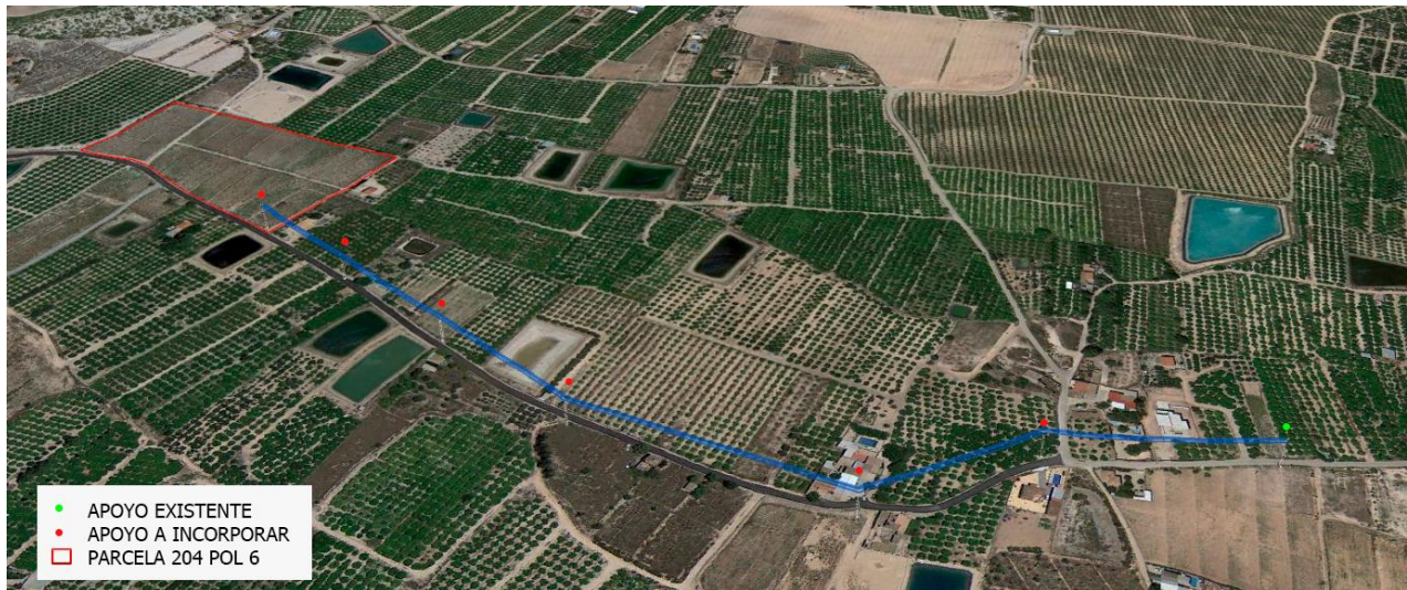
Figura 4: Construcción de línea AT desde apoyo existente hacia parcela 204 del polígono 6, para dar servicio al bombeo.
