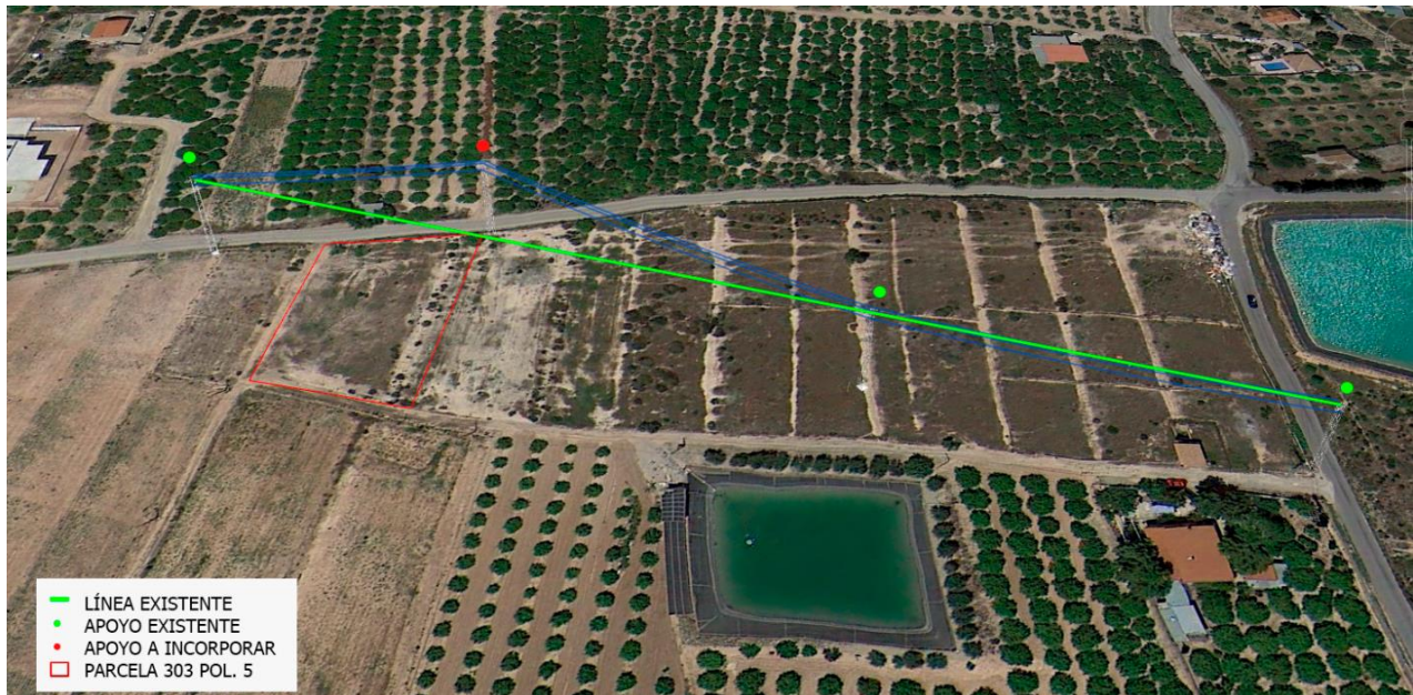
Figura 5: Modificación de conducción existente alrededor de la parcela 303 del polígono 5 que alojará la nave de filtrado
