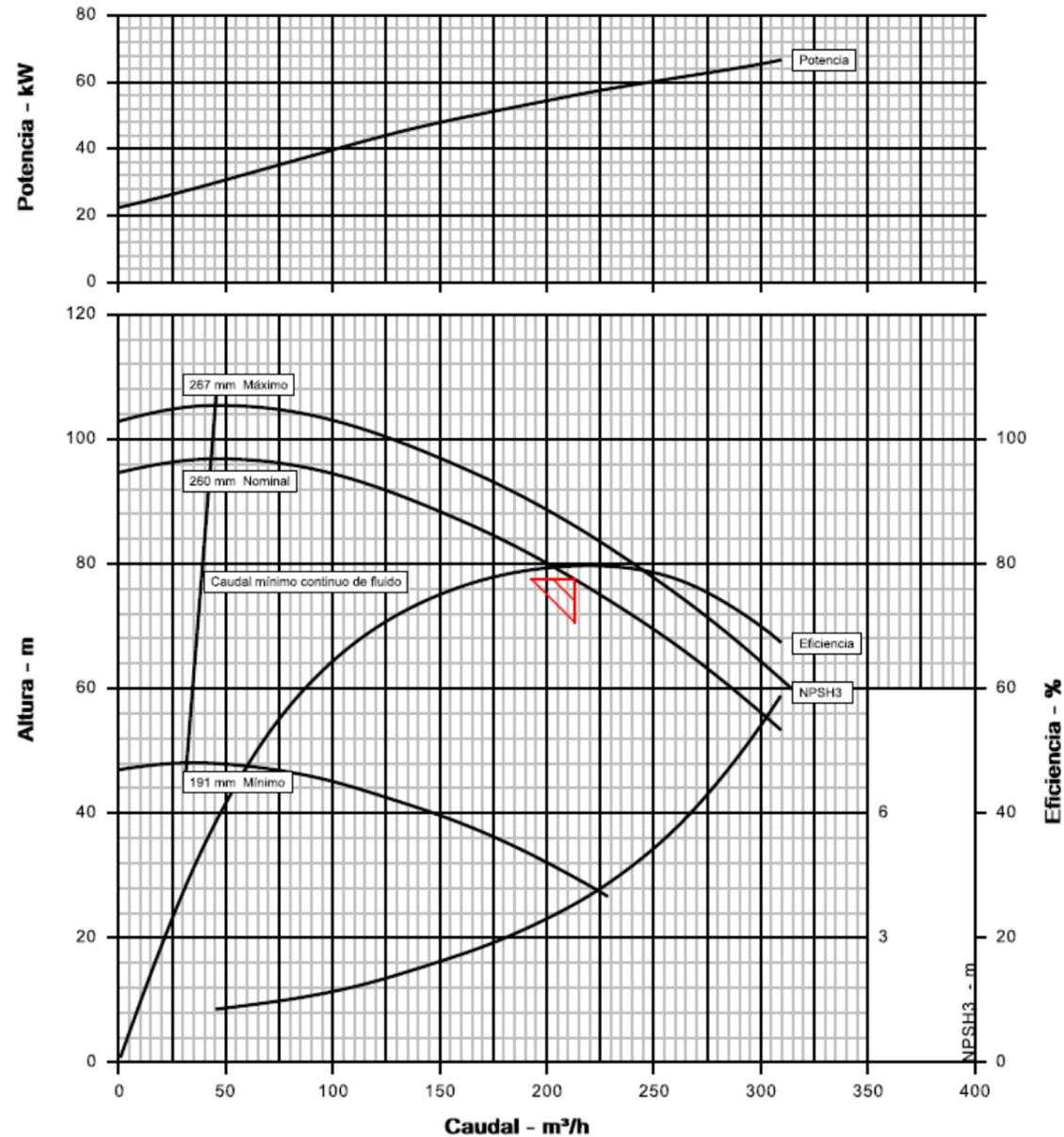
Se dimensiona un equipo de bombeo de cámara partida horizontal capaz de proporcionar 59,28 l/s a una altura de 77,5 m.c.a., accionados mediante motor eléctrico de 75 kW, 50 Hz 400 V a 2980 rpm, accionado por variador de frecuencia híbrido específico para funcionamiento solar. Además, deberá ser capaz de cubrir el rango entre los 9,7 l/s y los 59,28 l/s previstos con rendimientos de acuerdo a la curva anterior.
