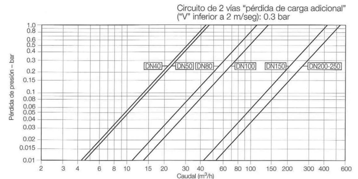
Figura 2.- Pérdidas de carga en la válvula hidráulica.
