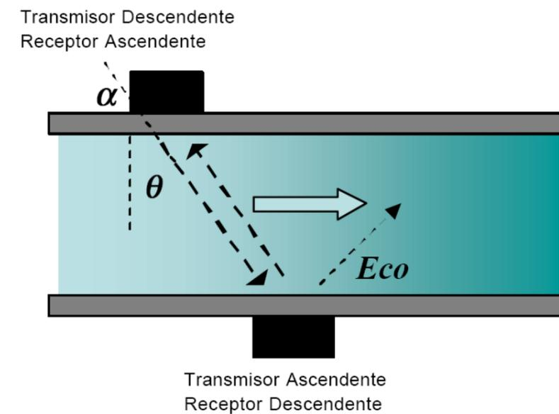
En todos los casos son equipos no intrusivos para la medición por el exterior de la tubería, mediante los sensores adecuados. El fluido será homogéneo y limpio. El rango de medida de velocidad del agua por los sensores externos será entre 0,3 a 15 m/s. El rango de temperaturas del fluido de funcionamiento de los sensores será hasta  $80^\circ\text{C}$ . La protección ambiental de los equipos será IP-67.
