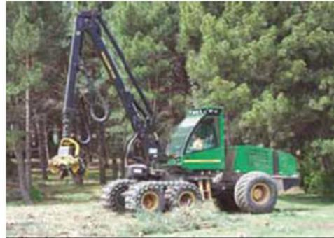
Son máquinas diseñadas para la recogida de madera mediante el procesamiento de árboles, incluyendo la corta, el desramado, el ronzado, el despuntado, el descortezado y el apilado de troncos.
