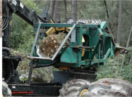
Suelen estar diseñadas para su instalación sobre la caja de un remolque autocargador, siendo la pinza, situada en el extremo del brazo articulado, la que se encarga de alimentarla, y admiten un montaje y desmontaje rápido, de manera que éste no pierda su capacidad para transportar troncos. En algunos modelos se utiliza un sistema de cámara en la que se comprimen los restos de poda mediante cilindros hidráulicos, con un atado posterior al completar el paquete.
