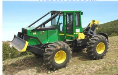
Su acción se complementa con el desemboscado con “skidder”, o con cargadores de troncos sobre remolques especiales, en los que también se pueden incorporar elementos para el empaquetado de los restos de poda.
