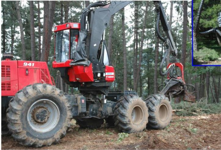
Para la utilización del procesador el maquinista bascula el cabezal de procesado, lo sitúa en posición vertical y lo encara con la parte baja del tronco del árbol que se va a derribar abrazándolo con las grapas.
