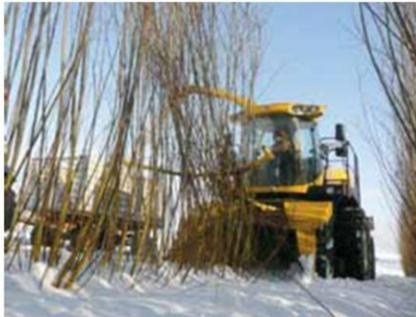
Recogida de arboles en corta rotación con picadora-cargadora
