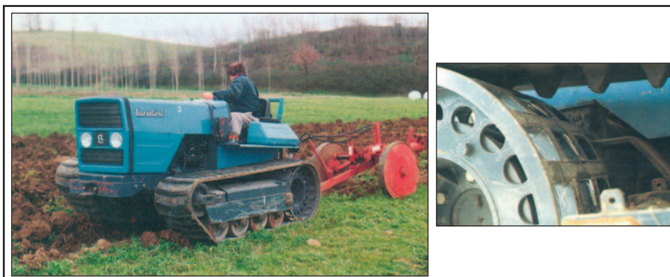
FIGURA 7.- PROTOTIPO DE LANDINI CON BANDAS DE GOMA DE ACCIONAMIENTO POSITIVO Y DETALLE DE LA RUEDA MOTRIZ
