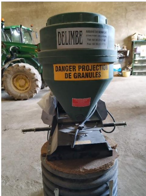
Máquina de aplicación de granulado con disco de distribución y detalle del disco.
