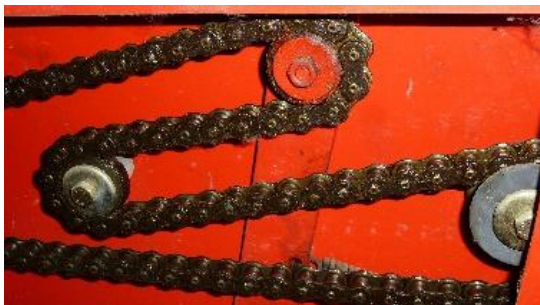
La protección de la toma de fuerza presenta defectos importantes. Las transmisiones de la potencia no presentan las debidas protecciones
