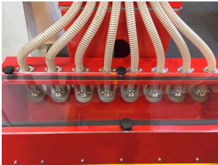
Múltiples salidas para el granulado cuya posición y orientación deben ser adecuadas para aplicar en todo el ancho de trabajo.
