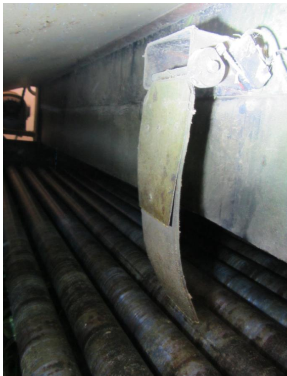
Sistema que detecta la circulación de la fruta en la línea y permite regular y detener el tratamiento cuando cesa el paso del material vegetal.
