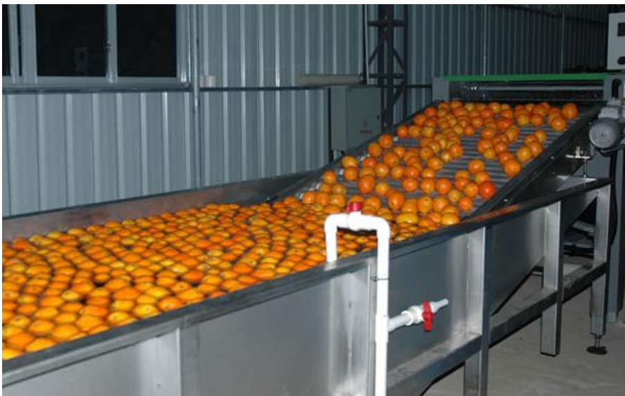
Figura 11. Sistema de extracción de la fruta de la balsa
