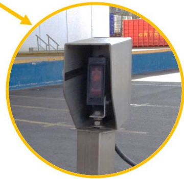
Sistema que controla el correcto posicionamiento del palet o palot en un drencher de cadena
