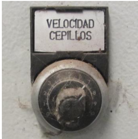
Dispositivo para el control de la velocidad de giro de los cepillos del equipo.
