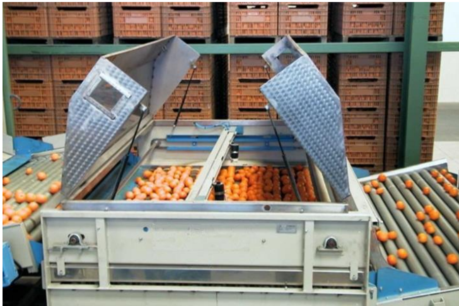
Figura 14. Aplicador de producto fitosanitario con o sin cera.
