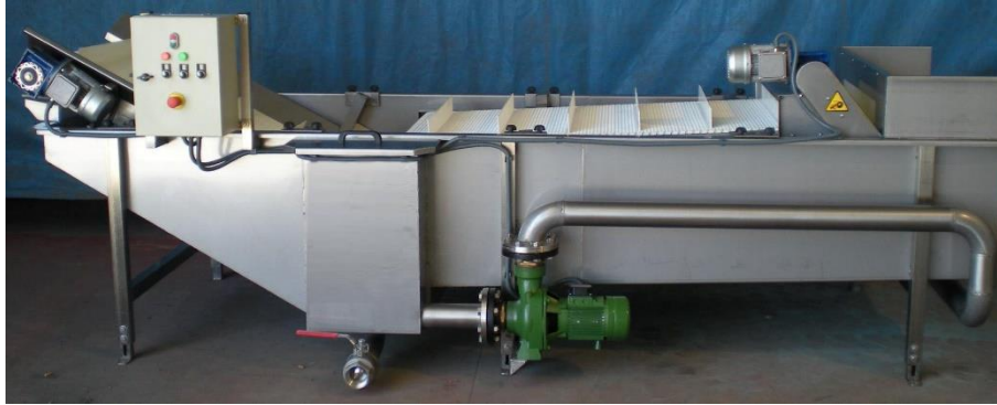
Figura 8. Balsa sin sistema de empuje de la fruta. Foto: Talleres Oliver
