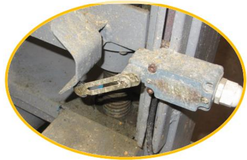
Sistema que controla el correcto posicionamiento del sistema de aplicación
