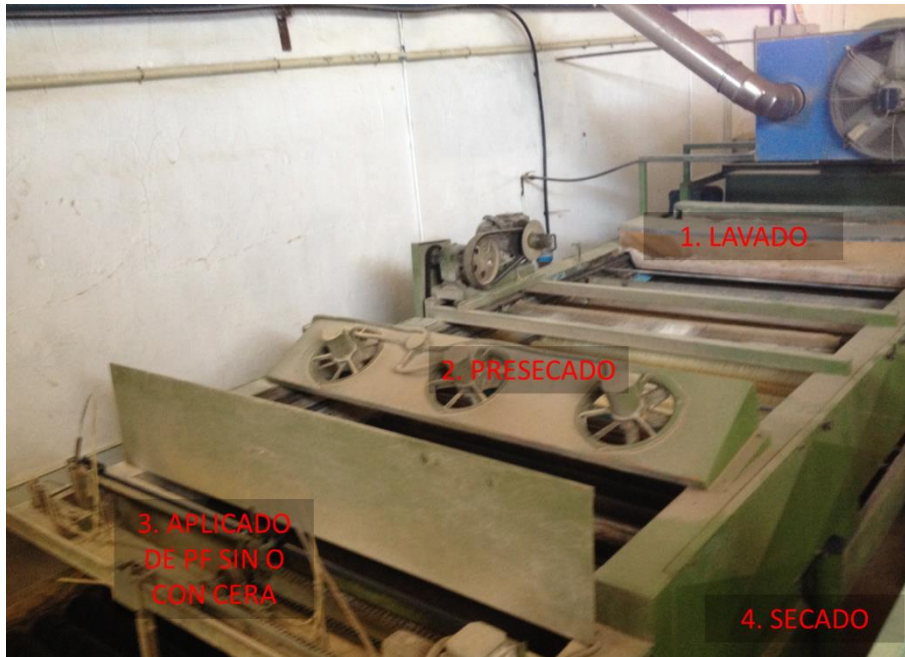
Figura 21. Equipo compacto con zona de lavado, presecado, encerado y secado de la fruta
