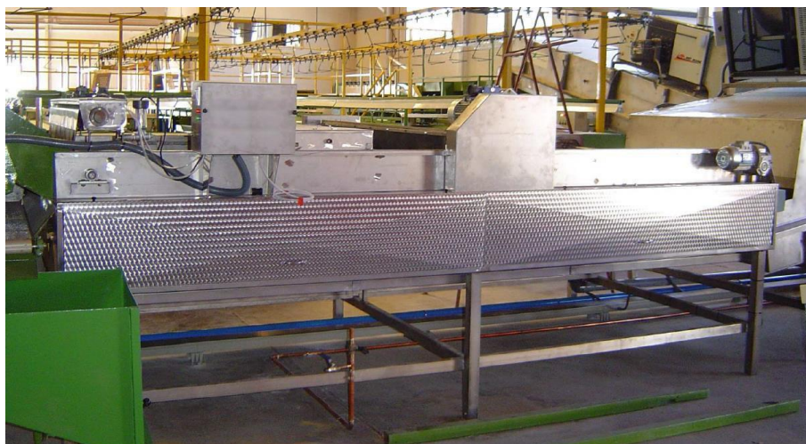
Figura 4. Aplicador de detergente más fungicida (lavadora).
