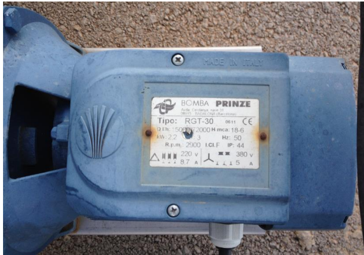
Placa de características de una bomba de alto caudal.
