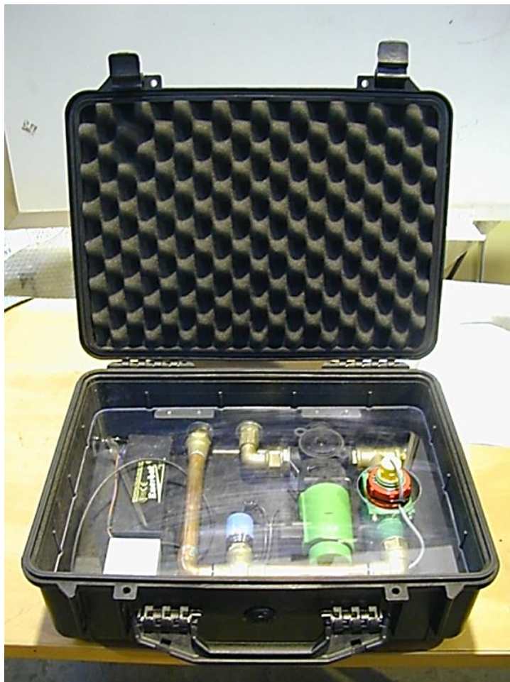
Instrumentación específica para medir el caudal una bomba de bajo caudal.
