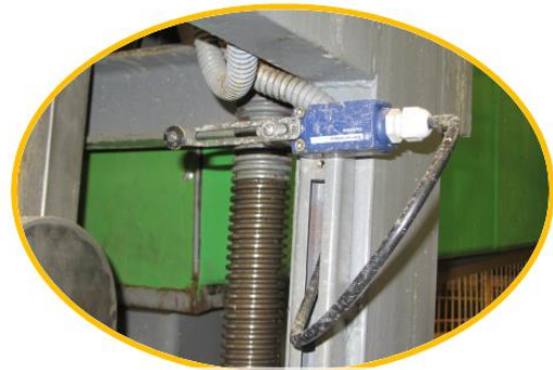
Sistema que controla el correcto posicionamiento del sistema de aplicación
