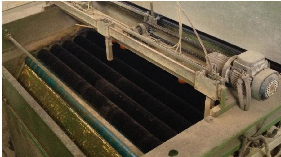
Figura 17. Detalle de los cepillos rotativos
