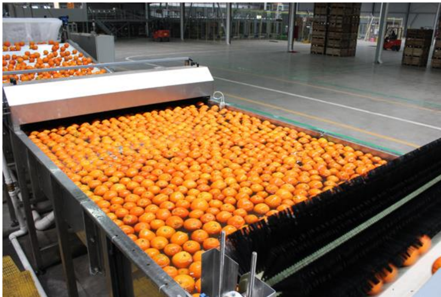
Figura 9. Balsa sin sistema de empuje de la fruta
