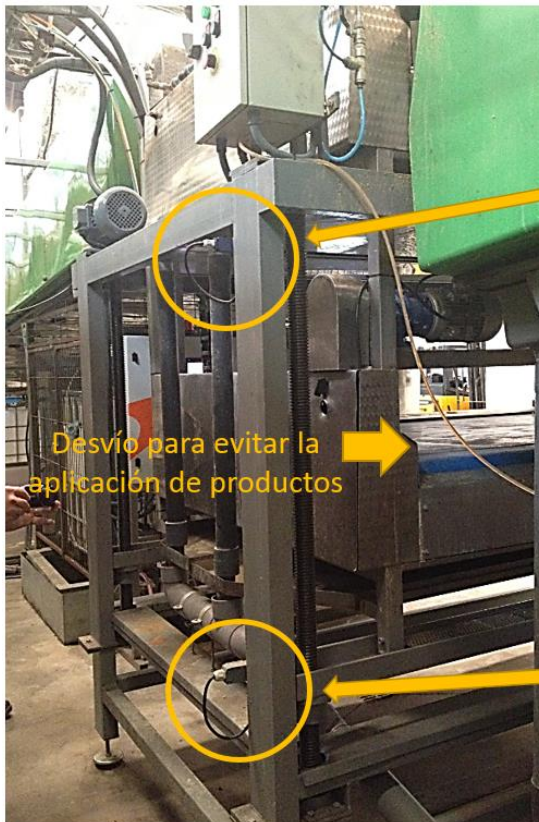
Sistema que controla el correcto posicionamiento del sistema de aplicación
