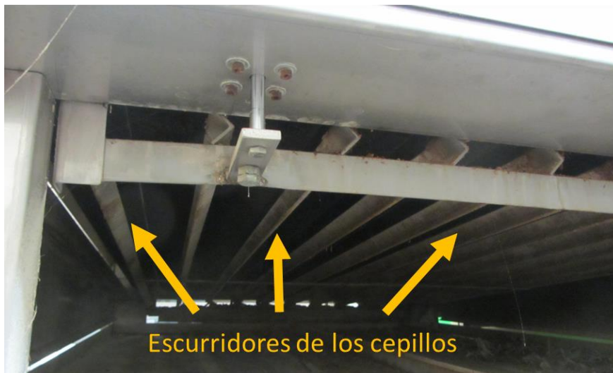
Dispositivo para escurrido de los cepillos de una enceradora
