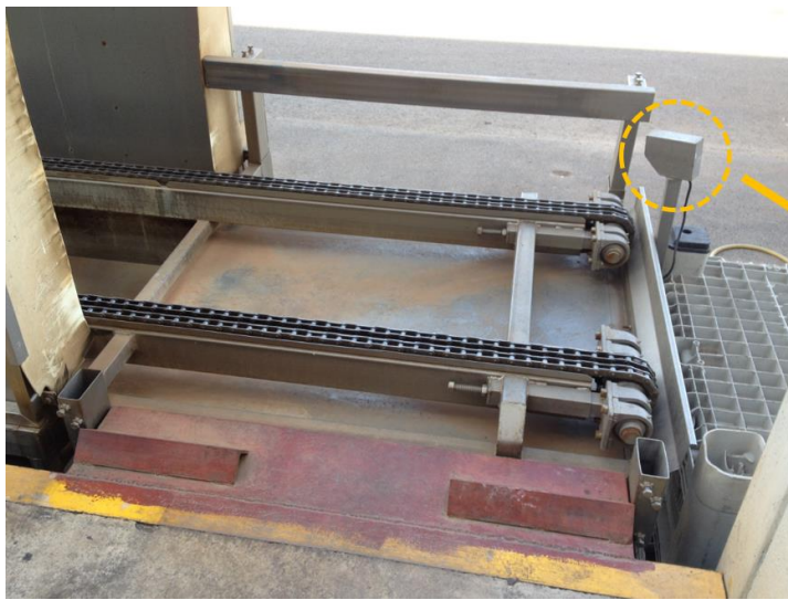
Sistema que controla el correcto posicionamiento del palet o palot en un drencher de cadena
