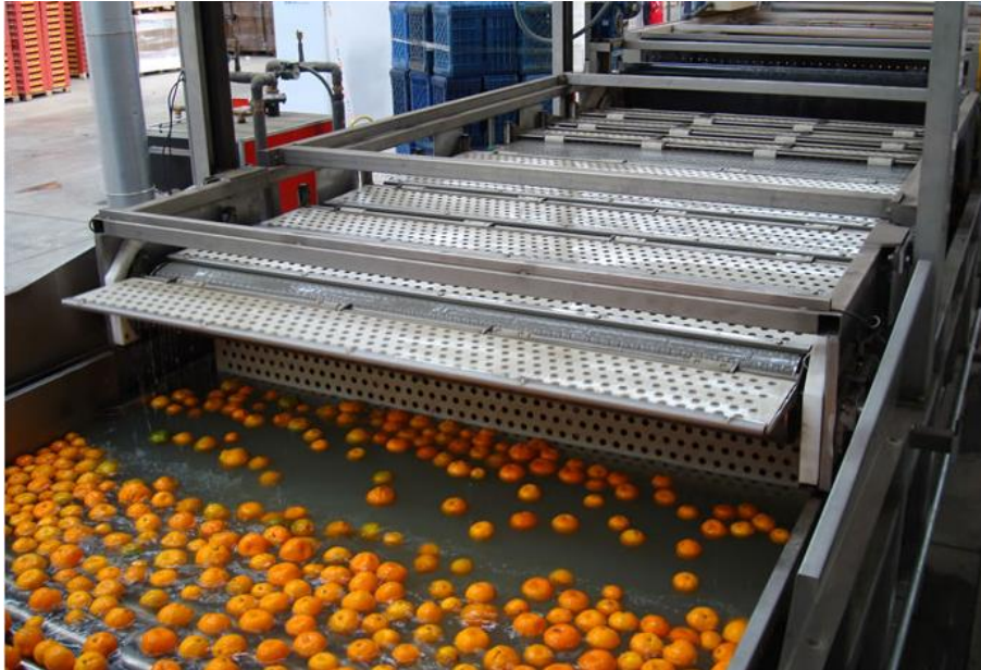
Figura 10. Balsa con sistema de empuje de la fruta
