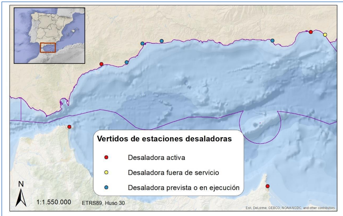
Figura 117. Situación de las desaladoras de agua de mar en la demarcación marina del Estrecho y Alborán. Fuente: MITECO, 2019i.
