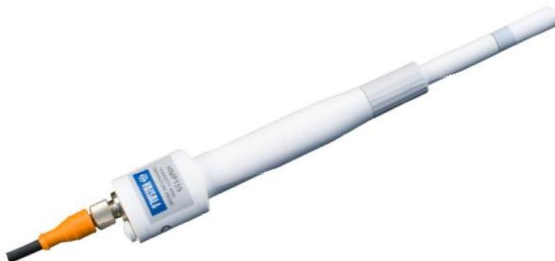
La sonda HMP155 al igual que la HMP45, mide temperatura y humedad relativa, los principios de medida son similares. Para medir temperatura se basa en la variación de resistencia que presenta el Platino a distintas temperaturas. Utiliza lo que Vaisala llama sensor Pt100 RTD 1/3 Class B IEC 751. Y para medir humedad utiliza un sensor capacitivo de humedad relativa llamado HUMICAP 180R, de Vaisala.
