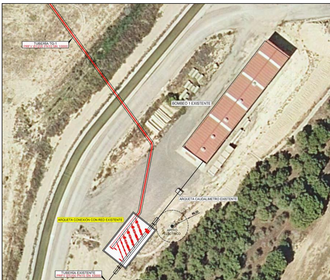
Figura 6: Croquis del bombeo 1 a sustituir.
