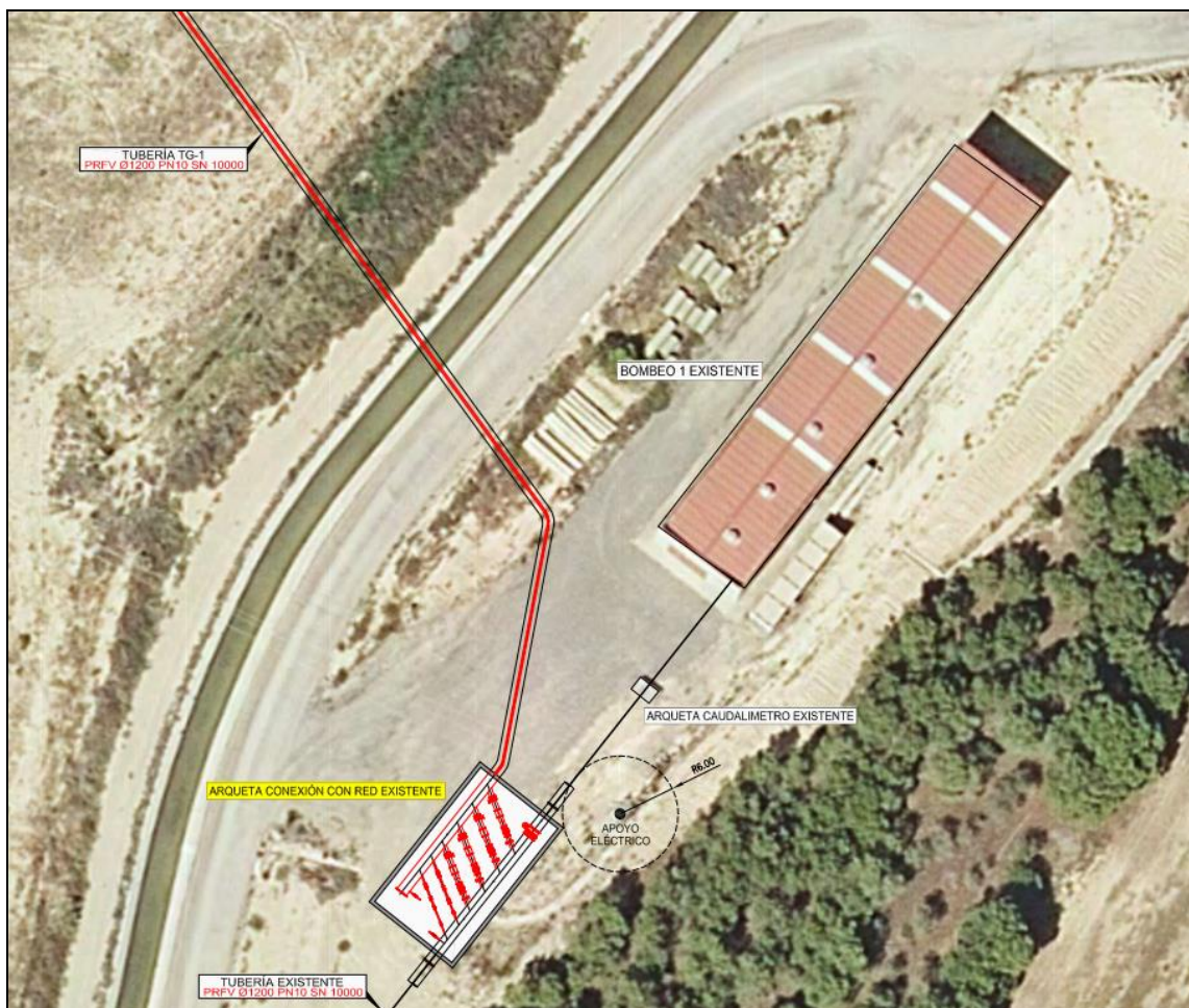
Figura 8: Croquis del bombeo 1 a sustituir.
