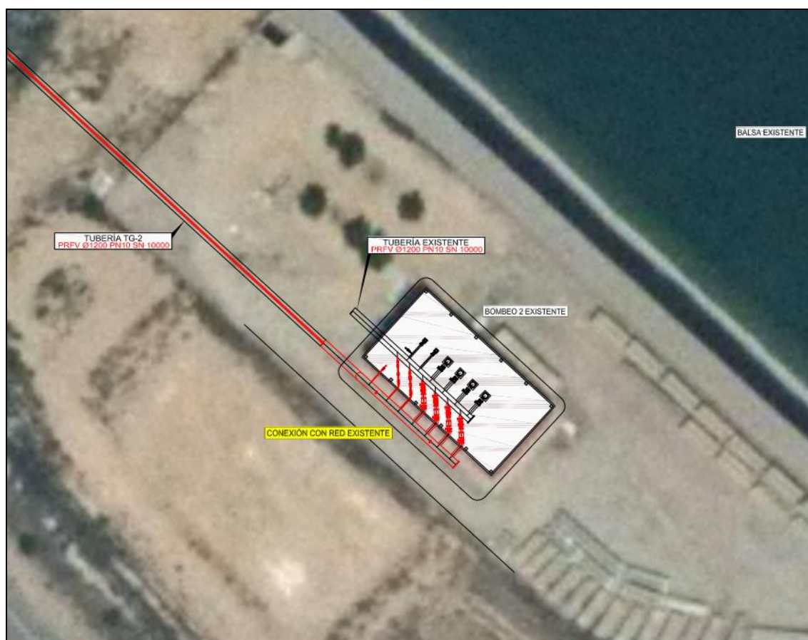
Figura 7: Croquis del bombeo 2 a sustituir.
