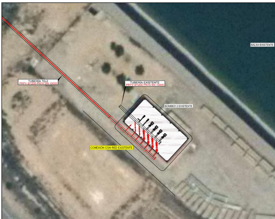
Figura 9: Croquis del bombeo 2 a sustituir.
