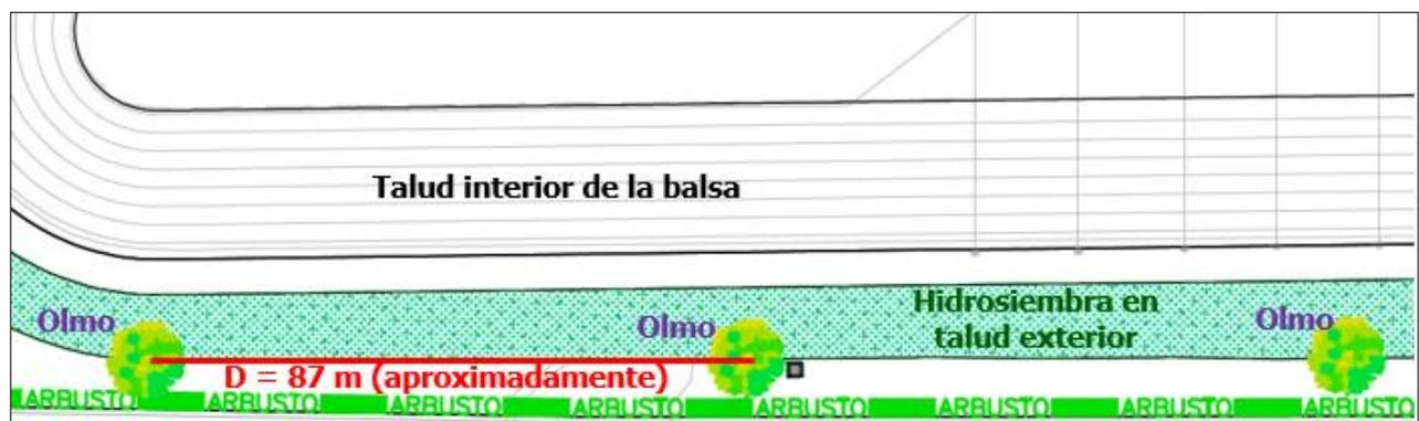
**Ilustración 1: Detalle de plantación de los olmos al pie del talud de la balsa.**
