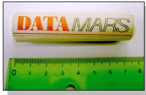
Ilustración 3. Bolo ruminal DataMars FDX-B
