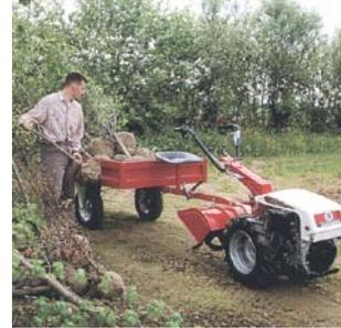
**Tractocarro tipo "estándar" derivado de un motocultor con 4 ruedas motrices (elementos no separables)**
