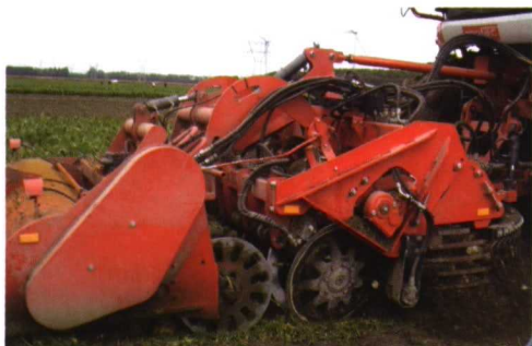
GRÁFICO 8.- CONJUNTO DESCORONADOR + ARRANCADOR CON RUEDAS ACCIONADAS (AGRIFAC)
