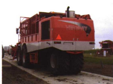
GRÁFICO 12.- SISTEMAS UTILIZADOS PARA REDUCIR LA PRESIÓN SOBRE EL SUELO
