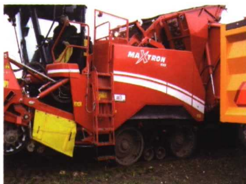
GRÁFICO 12.- SISTEMAS UTILIZADOS PARA REDUCIR LA PRESIÓN SOBRE EL SUELO
