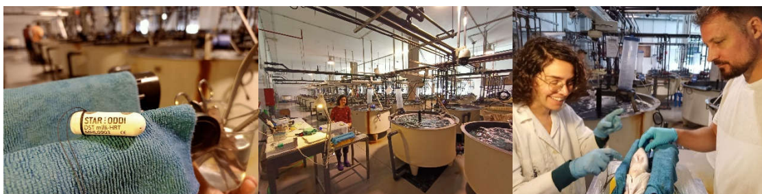
Figura 3.11. Izquierda: Sensor ( bio-logger ) modelo DST mili-HRT de la marca Star-Oddi® implantado en las lubinas del experimento. Centro: Mesa y herramientas de cirugía para la implantación de los sensores y tanques experimentales. Derecha: instantánea durante el proceso de la cirugía e implantación del sensor en una lubina.
