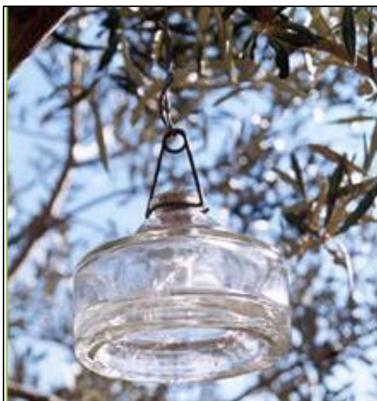
Figura 2: Trampa tipo McPhail (Fuente: NIMF 26)
