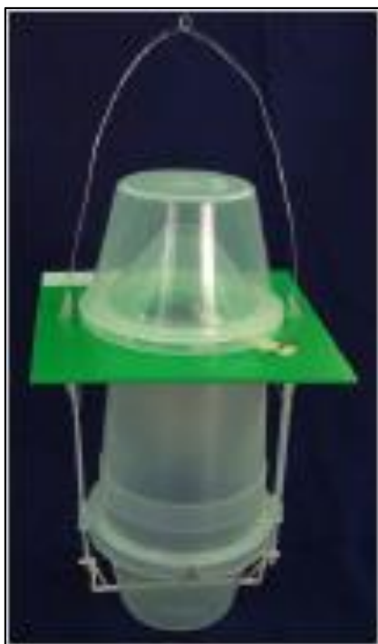
Figura 8: Trampas de embudo modificada (Fuente: NIMF 26)
