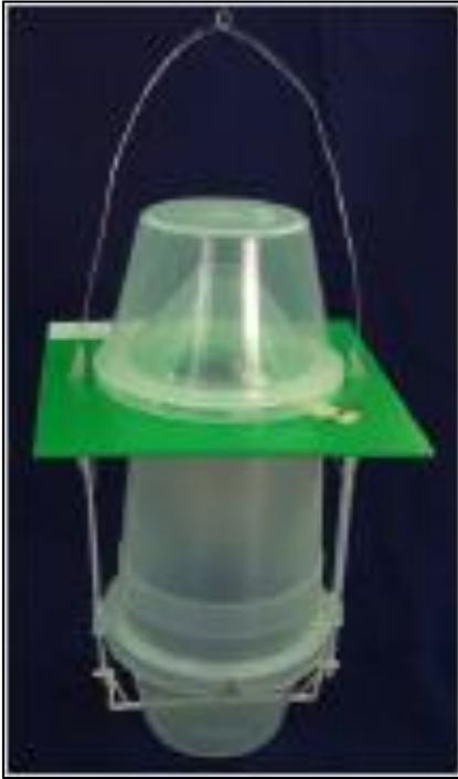
**Figura 8:** Trampas de embudo modificada (Fuente: NIMF 26)
