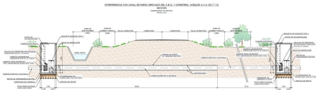
Imagen 9. Sección tipo de la hinca bajo el canal de riego
