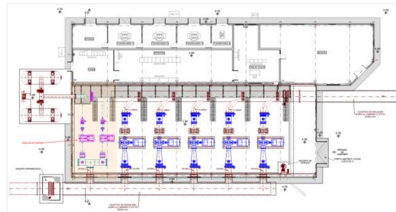
Figura 4. Zona de actuación y trabajos preliminares. Estación de bombeo del sector Belmonte
