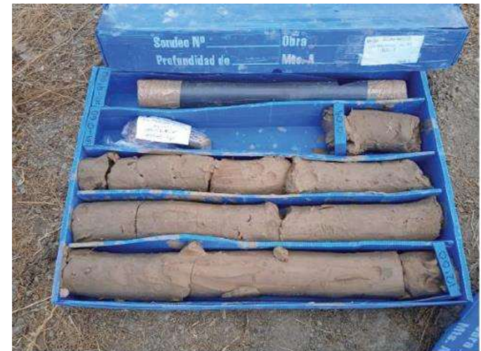
Imagen 45. Testigos del sondeo AS-1. Arcilla marrón claro con presencia de vetas limo-arenosos grises, a 10 m de profundidad.
