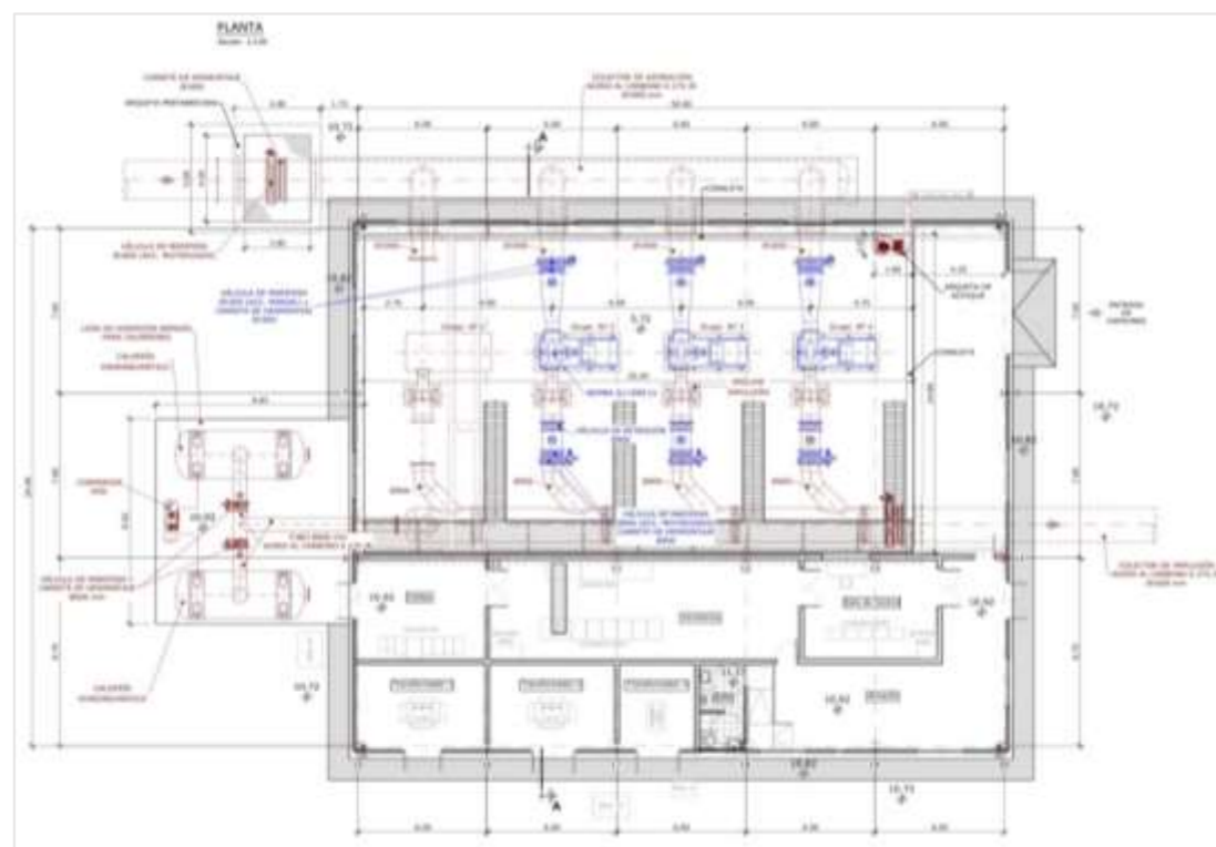
Imagen 6. Situación actual. Estación de bombeo a riego sector Alcantarillas
