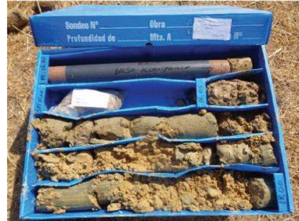
Imagen 44. Testigos del sondeo AS-2. Arena limosa con indicios de fragmentos de calcarenitas a 15 m de profundidad.
