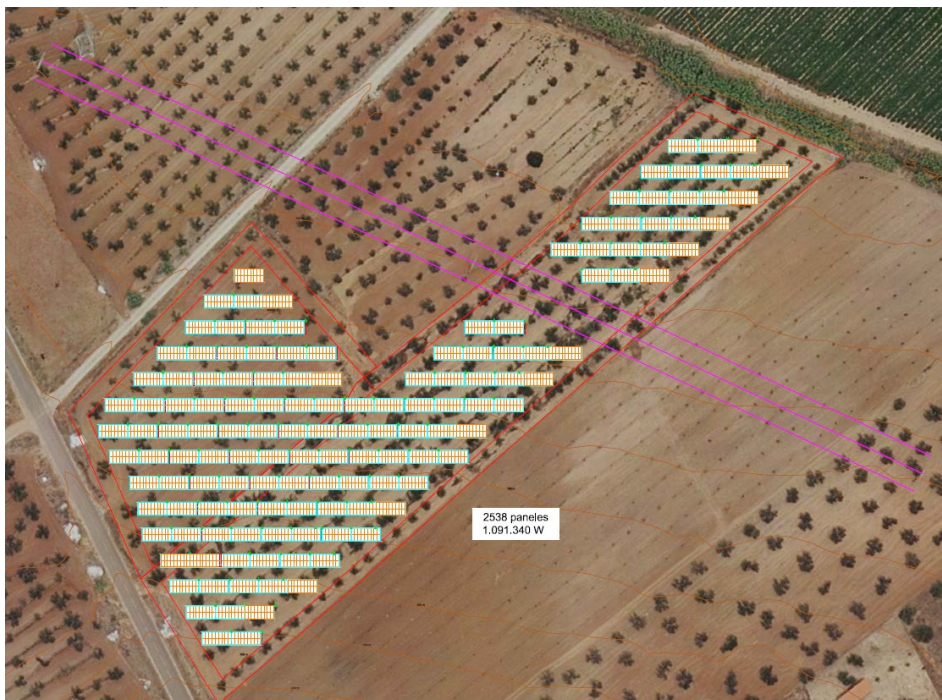
Figura 3. Distribución módulos fotovoltaicos Sector VIII.1 Alternativa 1
