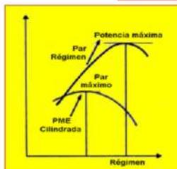
La potencia del motor depende del caudal de aire que entra en los cilindros. Sobre este aire se inyecta el combustible. La cantidad de combustible se limita para reducir el consumo específico y las emisiones de gases de escape.
