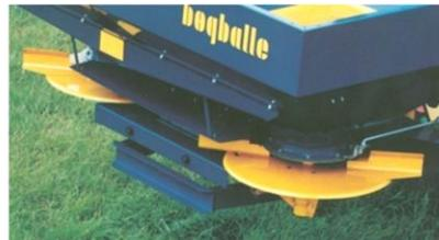
En algunas abonadoras la apertura de la salida de la tolva se hace de forma diferenciada a cada lado para asegurar que el cambio de dosis no afecte a la anchura de proyección.
