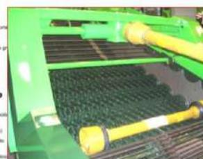
El grado de limpieza que se puede conseguir en una cosechadora depende en gran medida de las características y del estado del suelo sobre el que trabaja la máquina, pero también de la longitud del recorrido sobre el que se realiza la limpieza y de la eficacia de los sistemas utilizados.
