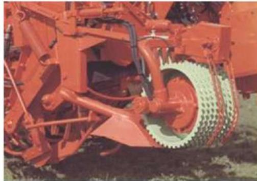
Realiza el descoronado de manera completa en una sola fase, seccionando la parte superior de la raíz de manera exacta y eliminando junto con la cabeza de la raíz todas las hojas incluso las más antiguas.
