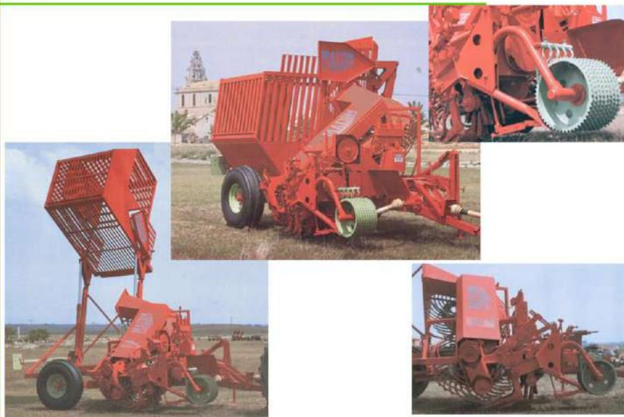
Realiza el descoronado y el arranque sobre una fila y la limpieza y el almacenamiento de las raíces en una tolva que descarga por basculamiento.
