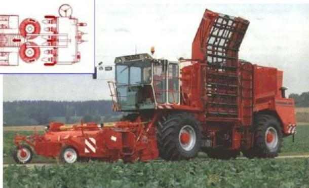
Tanto la unidad de descoronado como la de arranque van situadas por delante de las ruedas delanteras de la cosechadora, de forma similar al “cabezal” de las cosechadoras de cereales. El sistema de limpieza se sitúa debajo de una tolva de gran capacidad. Las ruedas de ambos ejes son de las mismas dimensiones. En algunos modelos puede desplazarse el eje de las ruedas traseras para que todo el suelo reciba una presión similar al paso de la máquina.
