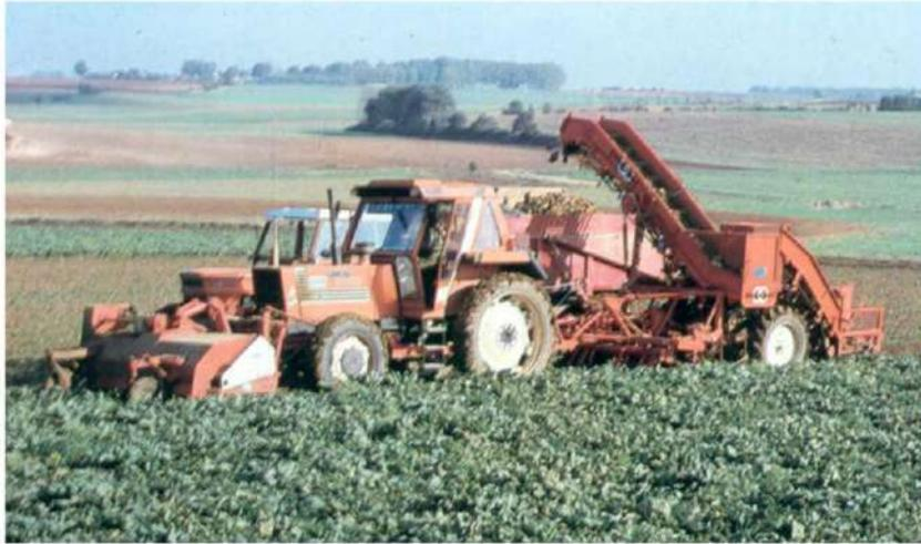
Otra alternativa es colocar la descoronadora en el enganche frontal de un tractor y la arrancadora-cargadora en la parte trasera. Este conjunto se comporta como una cosechadora integral.
