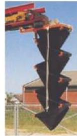
Para el movimiento de la patata en los almacenes y para la carga y descarga de vehículos se utilizan cintas transportadoras especiales que eviten la caída desde gran altura y los daños sobre la piel.
