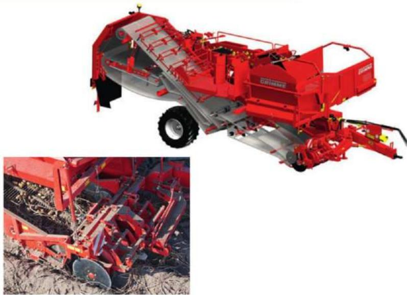
Detalle del arrancador para dos filas.
