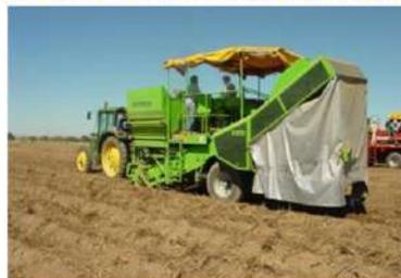
Para el arranque se pueden utilizar diferentes alternativas. Las más sencillas son el arado patatero y las arrancadoras de parrilla oscilante. En las cosechadoras el sistema de arranque se adapta al tipo de caballón y se completa con elementos para separar la patata de la tierra.
