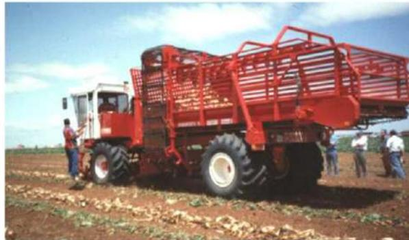
Como alternativa, se pueden utilizar la descoronadora y la arrancadora en el mismo tractor, dejando las raíces correspondientes a seis filas en un cordón central. que posteriormente se recoge con una cargadora limpiadora autopropulsada.
