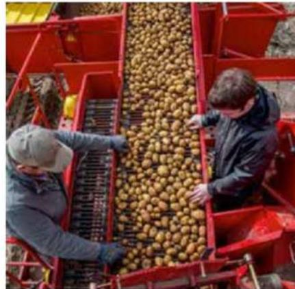
Detalle de la mesa de separación sobre la que trabaja el personal auxiliar. Limitación de la cantidad de patatas que se pueden seleccionar manualmente.
