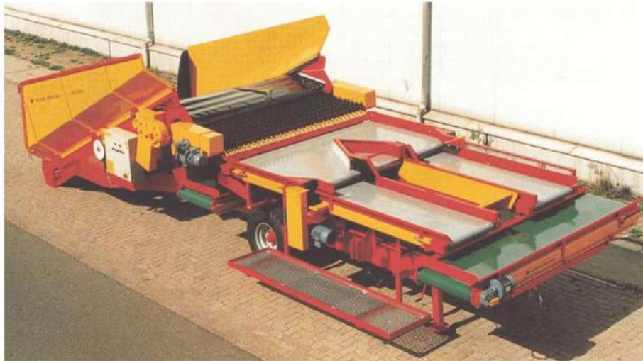
Cada vez es más frecuente que el proceso de recolección se complemente con un proceso de limpieza y clasificación que se realiza en una instalación fija, tanto si se procede al almacenamiento, como al envasado para la comercialización de la patata. Con independencia de las grandes instalaciones, en el mercado se ofrecen conjuntos modulares de inspección, clasificación y envasado que se utilizan en las grandes explotaciones o en las cooperativas.
