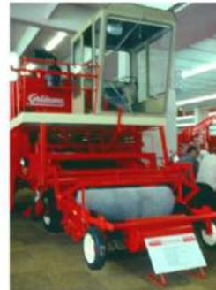
Generalmente son máquinas arrastradas, aunque también se ofrecen modelos que autopulsados y otros diseñados para su integración en un tractor agrícola. El bastidor incluye en su parte frontal los elementos de arranque y sobre el mismo los sistemas de limpieza y selección.
