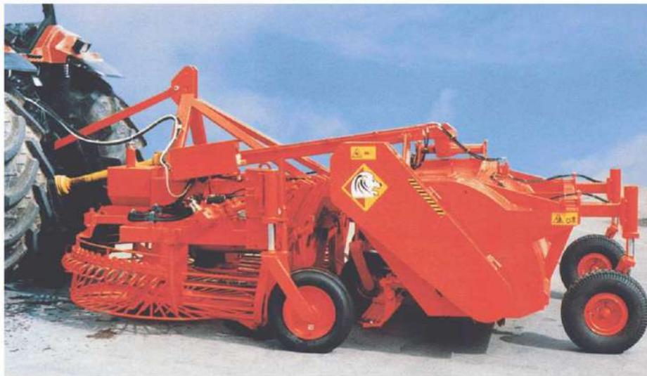
Trabaja sobre seis filas y se sitúa en un tractor con puesto de conducción reversible. Necesita que el enganche tripuntal del tractor tenga gran capacidad de elevación.
