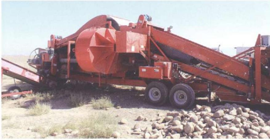
Equipo experimental (Agritechnica 2013) con eliminación de impurezas sobre las patatas elevadas por un colchón de aire
