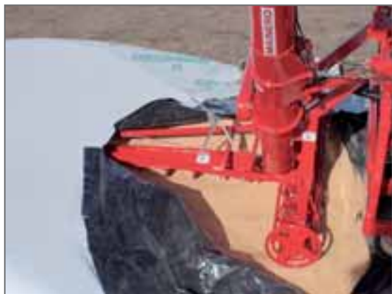
FIGURA 15.- DETALLE DE LOS SIN-FINES EN UNA EXTRACTORA DE GRANOS
