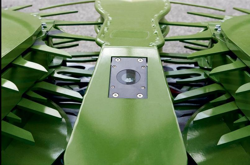
Autoscan: El sensor fotoóptico situado en el centro del cabezal de maíz mide la madurez de la planta
