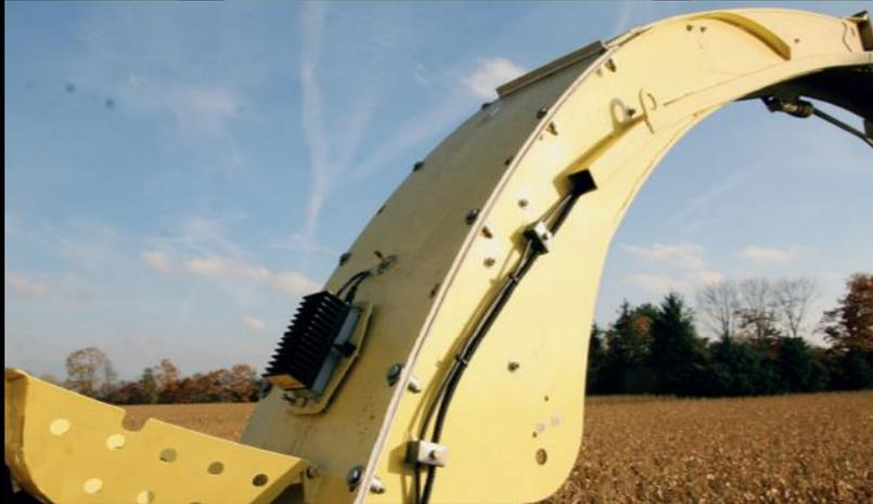
Sensor NIR en el tubo de descarga
