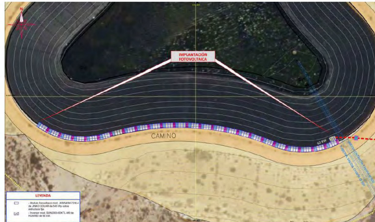
Fig. 8. Instalación fotovoltaica junto a la estación de bombeo balsa de Níjar
