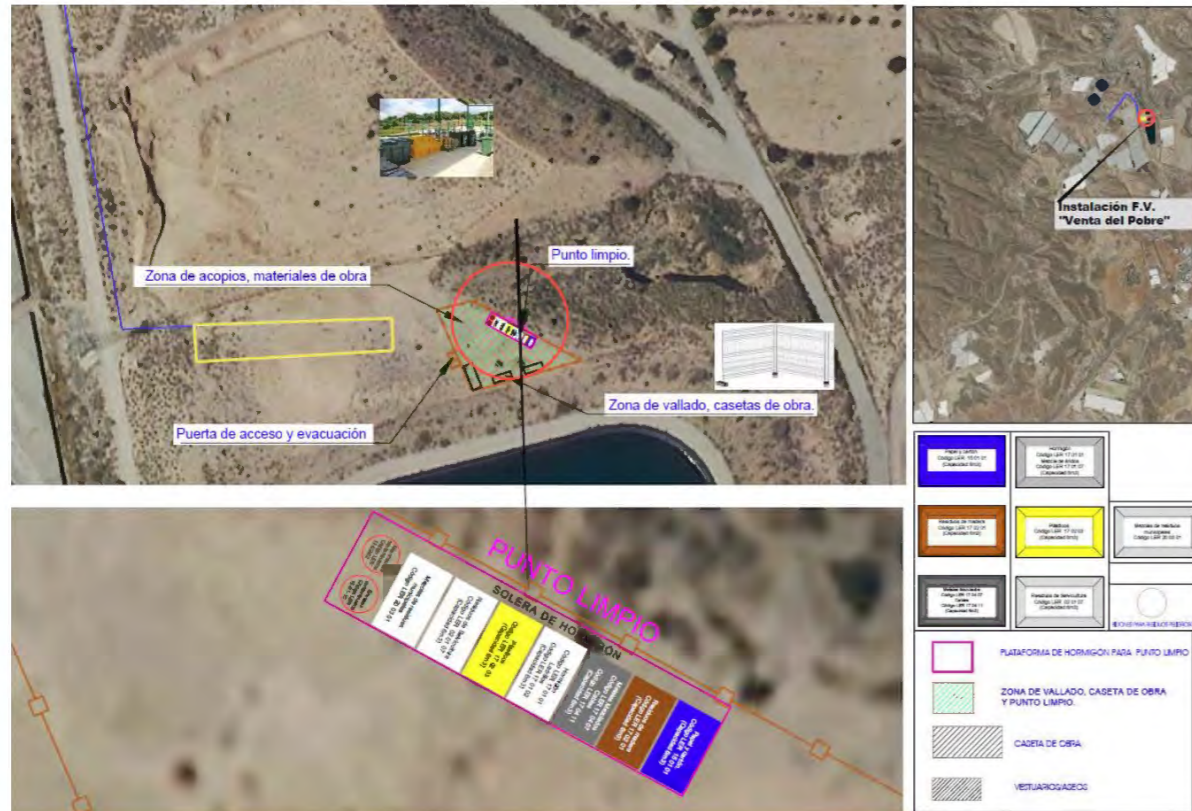
Fig. 17. Zona gestión residuos trabajos ejecución instalación fotovoltaica Venta del Pobre
