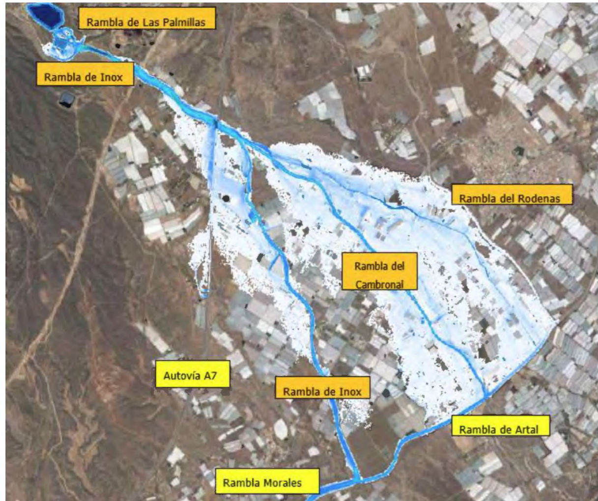
Fig. 124. Simulación de desbordamiento (la zona sombreada en blanco corresponde a las zonas de desbordamiento entre invernaderos, con lámina de agua menor de 30 cm).
