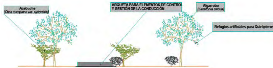
Fig. 130. Medidas correctoras. Barreras vegetales en zona de casetas desagüe-ventosas modelo B (plano 14 hoja 3/4)
