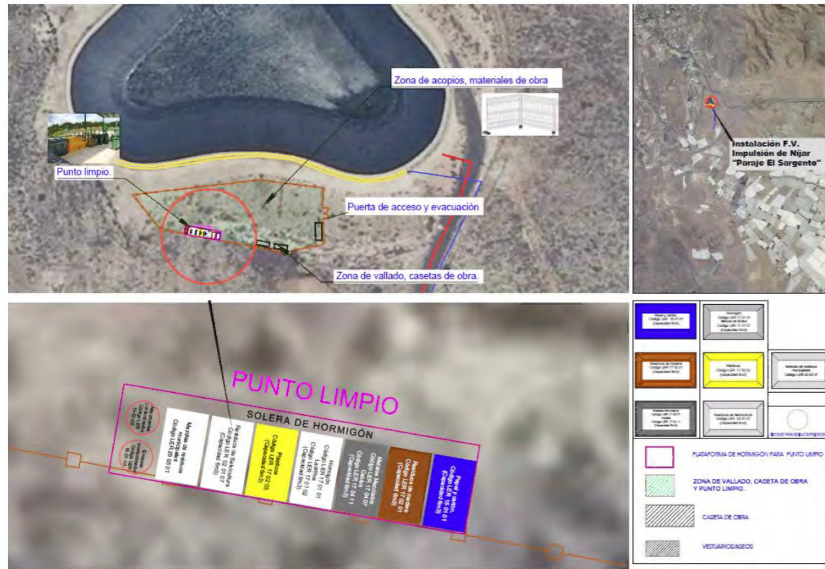
Fig. 16. Zona gestión residuos trabajos en la instalación fotovoltaica paraje El Sargento
