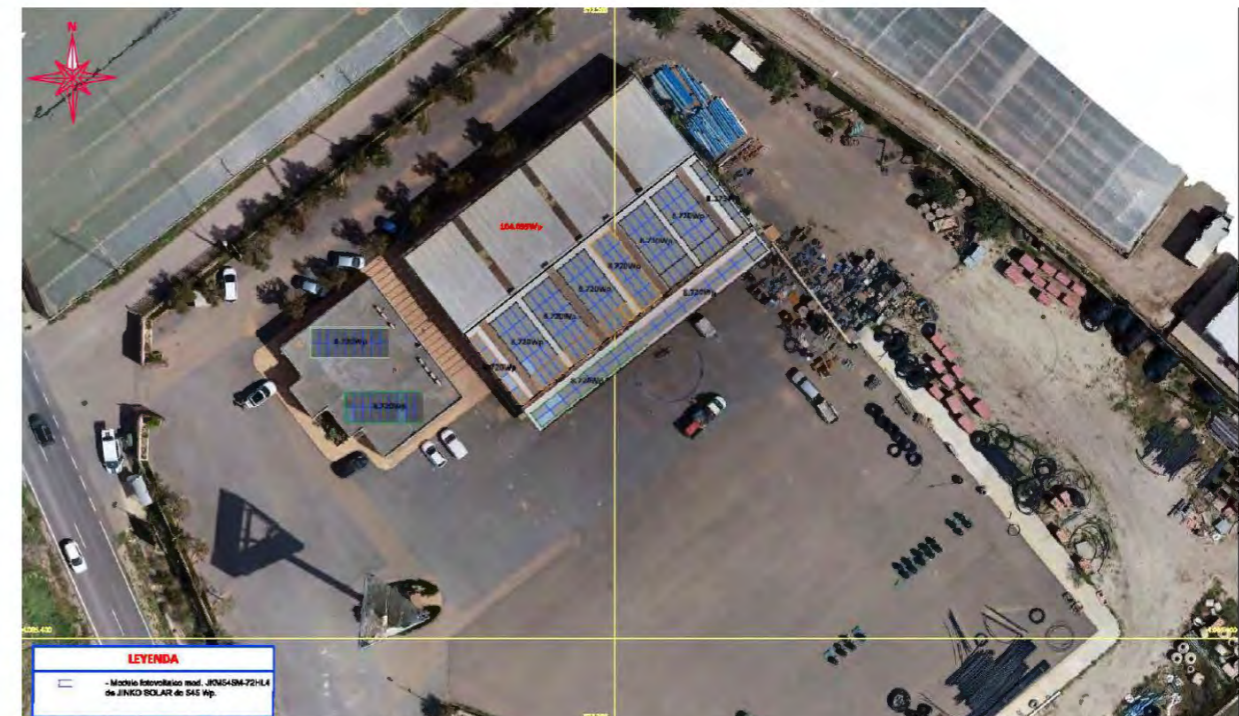
Fig. 7. Instalación fotovoltaica sobre la cubierta de la oficina de la CUCN
