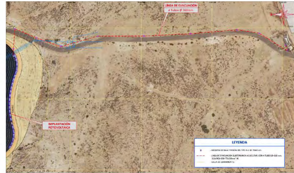
Fig. 9. Línea de evacuación instalación fotovoltaica balsa de Níjar
