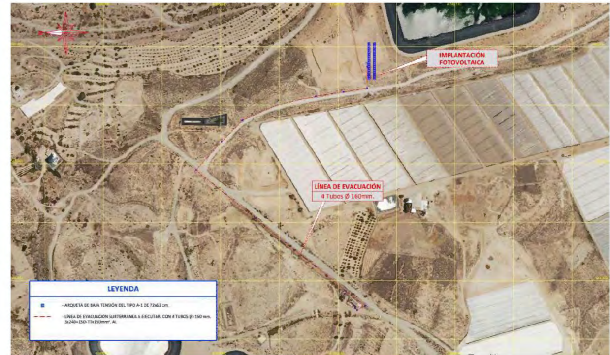
Fig. 11. Línea de evacuación instalación fotovoltaica Venta del Pobre
