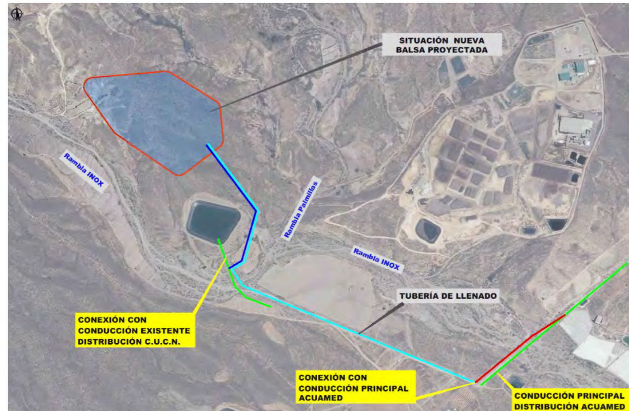
Fig. 24. Ejecución de las nuevas balsas próxima a la existente de ACUAMED, en el paraje del Jabonero (plano 1. Hoja 4/4)
