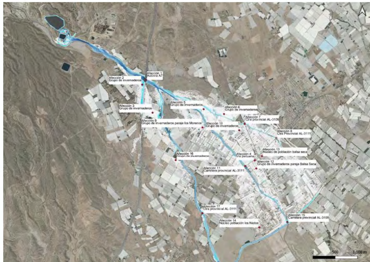
Fig. 125. Elementos y zonas sensibles (la zona en blanco corresponde a las zonas de desbordamiento entre invernaderos, con lámina de agua menor de 30 cm).
