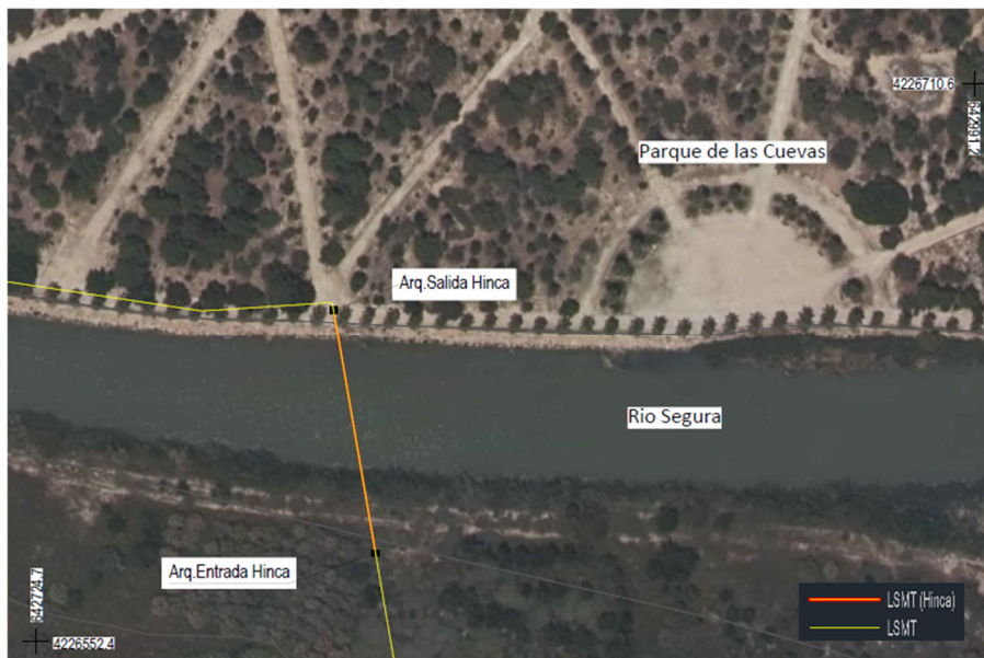
Cruzamiento subterráneo con el río Segura
