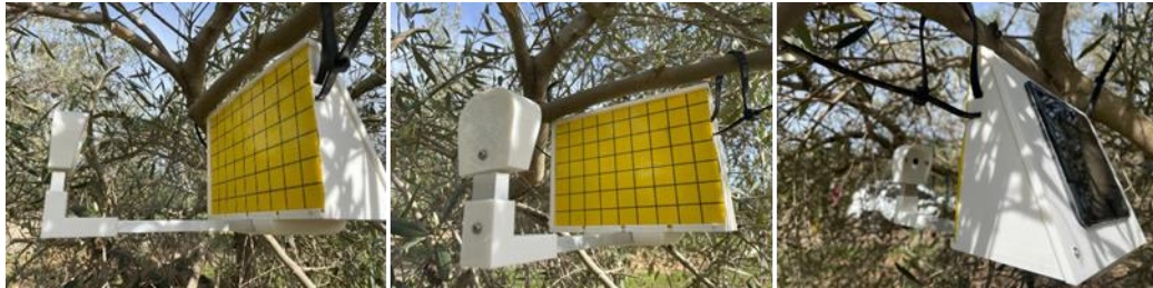
Fig. 24. Trampa electrónica autosuficiente funcionando en el campo.
