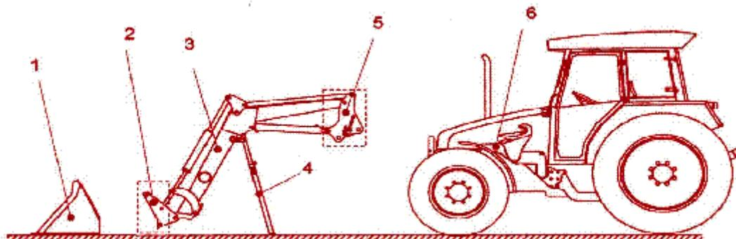
1.- Herramienta 2.-Dispositivo de enganche de la herramienta 3.- Brazo elevador 4.- Soporte de apoyo 5.- Dispositivo de fijación al bastidor 6.- Bastidor montado sobre el tractor
