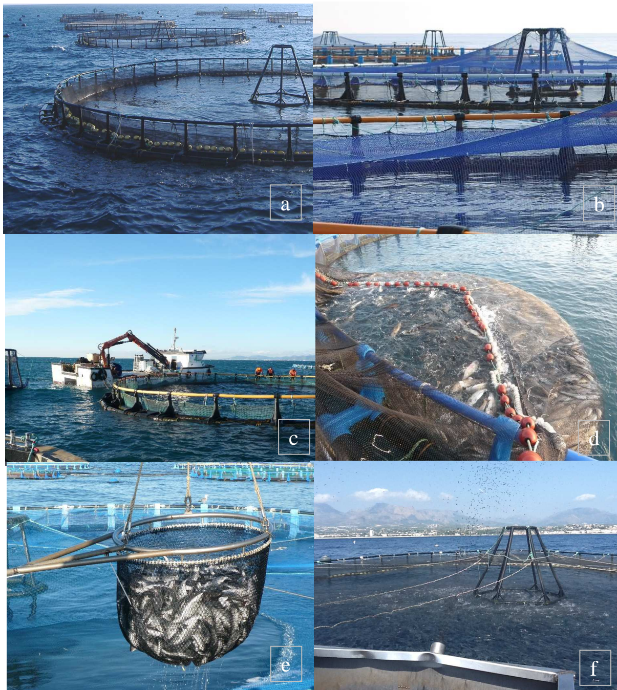
Figura 21. Jaulas flotantes en aguas costeras de la Comunitat Valenciana para el engorde de Dorada, Lubina y Corvina. Cada instalación incluye varias jaulas circulares flotantes, fijadas al fondo por un entramado de cables, boyas y fondeos (a y b). Los trabajos de explotación y mantenimiento requieren el uso de embarcaciones de apoyo (c) y maquinaria especial. d y e) Despesque mediante red de concentración y salabreo. f) Alimentación mediante cañón de pienso.
